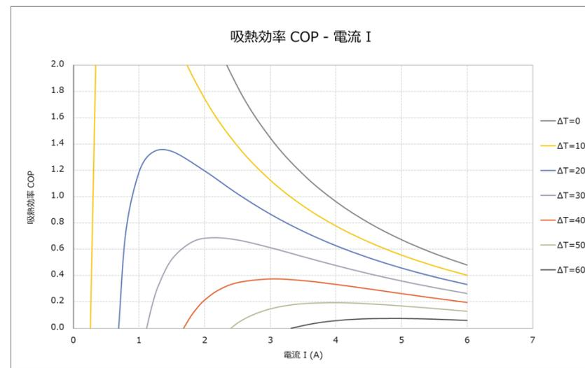
T<sub>h</sub> : 放熱側の温度, T<sub>c</sub> : 冷却側の温度, ΔT: 放熱側と冷却側の温度差 (ΔT=T<sub>h</sub>-T<sub>c</sub>), 各特性値は大気圧、雰囲気温度22±2°Cの条件下で測定
